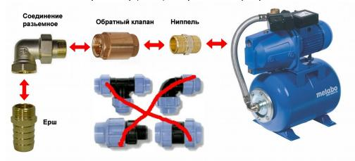
5) Трубу скважины отрезать до нужного размера, разогреть строительным феном (не перегреть!) или кипятком. Ерш смазать силиконом или любой пластической смазкой и вставить в трубу. ВНИМАНИЕ! Зажимные соединения типа Unidelta не использовать!
